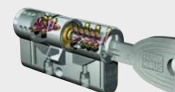
Der **Hochsicherheitszylinder** mit dreidimensionaler, patentierter Abtast- und Aufbohrschutz sowie Zieh- und Abreiß-Sicherung. Die große, spezielle Schlüsselform ermöglicht leichtes Sperren und verhindert Verbiegen und Abbrechen des Schlüssels. Er ist beidseitig sperrbar. Der symmetrische Wendeschlüssel kann sehr leicht in den Zylinder eingeführt werden.
