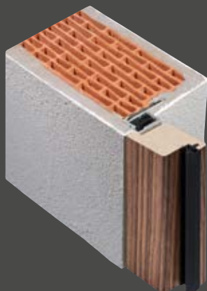
BLENDRAHMEN BM 43/65 in der Laibung mit Blindstock montiert
