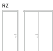
Raumhohe Zarge mit Querteil ohne Kämpfer bis Stocklichhöhe von 2.520 mm (einflügelig, zweiflügelig)
